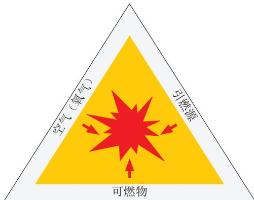
因此，避免点燃易燃物质或将爆炸的影响降至安全水平十分重要。所有在潜在爆炸性环境中使用的设备，均必须严格按照其适用的法规和标准进行设计、生产和标记。
