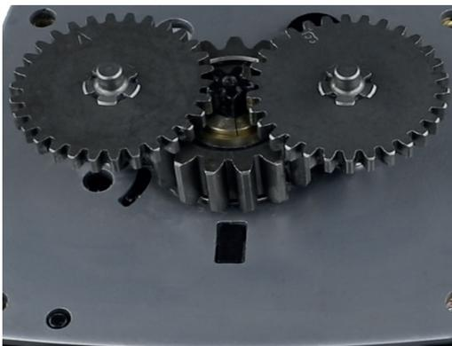
所有手动葫芦的齿轮箱均充分润滑。OMEGA Atex 型号产品和所有气动环链葫芦的齿轮部件都需要充分润滑运行,因此这些部件均加入了液体浸润“k”。润滑(润滑油或润滑脂)可防止齿轮装置产生火花。
